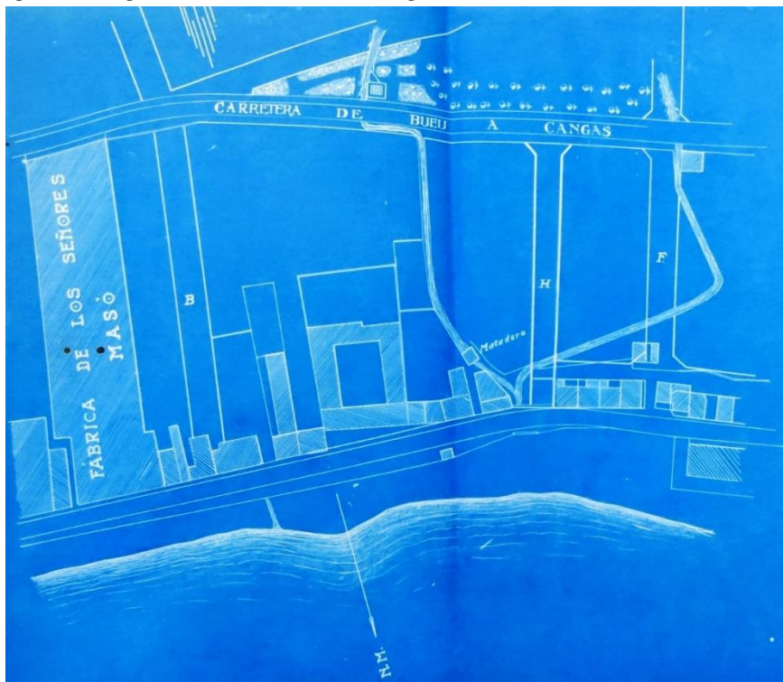
Figura 105. Plano xeral do Proxecto e construción da rúa H do Plano de Poboación de Buen de 1932, por Rafael Picó. Pódese observar a localización do antigo Matadoiro, e como ignora o paso do río. Ao sur, localizado cun bosquexo o mercado trapezoidal proxectado por Picó en 1940. A rúa B, xa proxectada, aínda non estaba executada
